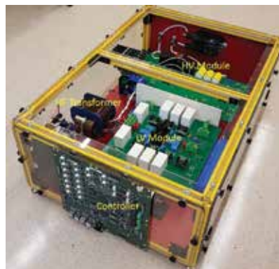
25kVA, 2.5kV/600V DC or 480V AC converter module.
